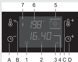
Utilisez le programmateur électronique pour régler le temps et la température de cuisson.
