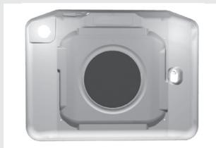
L'utilisation du filtre antigraisse est vivement recommandée durant la cuisson de la viande. Situé sur la paroi arrière du four, le filtre protège le ventilateur, les résistances et les parois de l'appareil des éclaboussures de graisse. Retirez toujours le filtre pendant la cuisson des pâtisseries ; si vous le laissez en place, les résultats risquent d'être décevants pour certains gâteaux.
