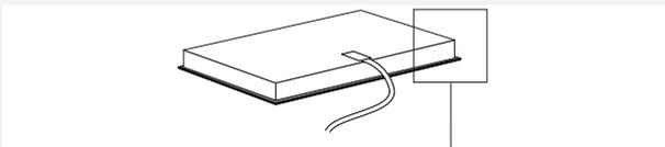
Retirez la bande adhésive qui protège le joint et collez-le dans le creux du profilé en aluminium ou sur le pourtour de la vitrocéramique. Ne faites pas tourner le joint dans les coins, mais découpez quatre bandes distinctes pour les quatre côtés, afin que le joint adhère proprement dans les coins, sans débordement.
