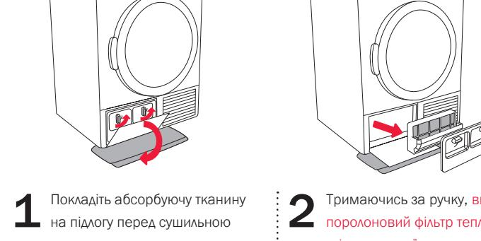
1 Покладіть абсорбуючу тканину на підлогу перед сушильною машиною.
