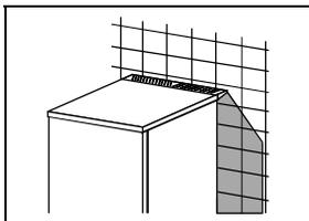
Til skab der ikke er udstyret med ventilationsgitter medfølger to afstandsstykker, som monteres på kondensatorens øverste kant. Afstandsstykkerne forhindrer, at skabet placeres for tæt indtil væggen. Afstandsstykkernes længde afhænger af den afstand der skal være fra kondensatoren til væggen. Vend derfor afstandsstykkerne tilsvarende og monter dem på apparatet. Herved sikres den nødvendige mængde luft til nedkøling af rørene.
