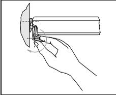
Ziehen Sie den Türverschluss in Ihre Richtung und öffnen Sie die Tür. Sorgen Sie dafür, daß der Riegel beim Schließen einschnappt. Im Falle von schlecht geschlossener Tür, wird diese durch die Sicherheitsfeder geöffnet. Schließen Sie die Tür noch einmal!
