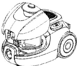
3. Odmaknite posodo od aparata in jo izpraznite tako, da pritisnete gumb, da se le ta odpre.
