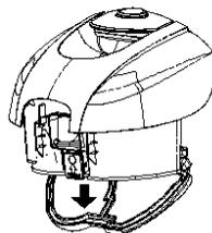
5. Замените пылесборный отсек до того, как зафиксируете его.
