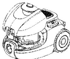
3. Pojemnik odsunąć od urządzenia i opróżnić go, przyciskając przycisk na dnie pojemnika, aby się otworzył.
