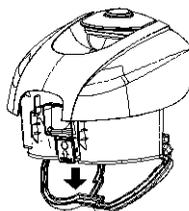
5. Poziționați subsamblul compartimentului de colectare a prafului până se închide.
