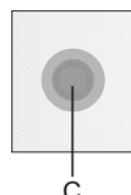
O indicador luminoso **C** intermitente quando a temperatura do congelador fica demasiada elevada e se apaga automaticamente quando fica suficientemente baixa para afastar qualquer risco de degradação dos alimentos (ver o capítulo »Guia de reparação«).
