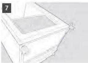
Αφαιρέστε την κάτω βάση μεντεσέ χρησιμοποιώντας το κλειδί 8 mm. Αφαιρέστε και τοποθετήστε ξανά τον πείρο χρησιμοποιώντας το κλειδί 10 mm για να ξεβιδώσετε το παξιμάδι και ένα επίπεδο κατσαβίδι για να αφαιρέσετε τον πείρο. Μπορεί να χρειαστεί να πιέσετε τον πείρο από κάτω για να τον αφαιρέσετε πλήρως.
