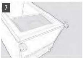
Îndepărtați balamaua inferioară folosind o cheie de 8 mm.
