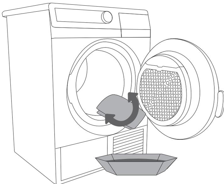
Перед первым использованием сушильной машины очистите барабан влажной тряпкой с добавлением мягкого моющего средства.
