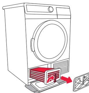
**2** Зніміть кришку. Поверніть ручку конденсатора вгору та витягніть конденсатор, взявшись за неї.
