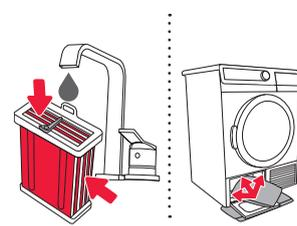
**3** Промийте обидві сторони внутрішньої частини конденсатора та ретельно висушіть. Використовуйте вологу тканину, щоб очистити відсік, у який встановлюється конденсатор.
