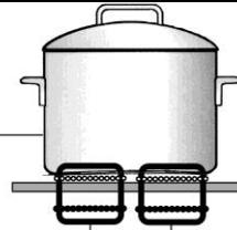
Geschirr mit ferromagnetischem Boden
