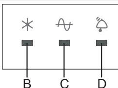
Zapnite spotrebič a otáčajte volič teploty do pozície intenzívne mrazenie \* (»super mrazenie«).
