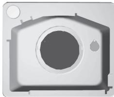
Ugrađeni filter za masnoću, postavljen na stražnjoj stjenci pećnice, štiti ventilator, okrugli grijач i pećnicu pred neželjenim mazanjem masnoćama. Filter uvijek namjestite kad pečete meso. Ako pečete kolače, uvijek ga odstranite! Namješten filter kod pečenja orehnjače može biti uzrok slabijim rezultatima pečenja.
