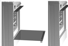
**⚠ Робота інфрачервоного нагрівача не регулюється за допомогою термостата — нагрівач увесь час працює на повну потужність, тому потрібно відкрити або зняти дверцята духовки та встановити захисний щит під панель керування (вставте щит під нижні монтажні гвинти панелі керування).**
