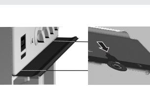
**Щит** панелі керування захищає кнопки та таймер/годинник панелі керування від пошкодження через використання газового інфрачервоного нагрівача. Щоб установити щит, дотримуйтесь інструкцій у розділі «Готування за допомогою газового інфрачервоного нагрівача».
