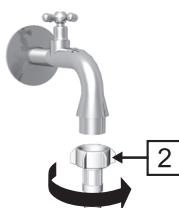
**⚠ Заливной шланг необходимо прикрутить руками достаточно плотно, чтобы не протекала вода. После прикручивания проверьте герметичность соединения. При подсоединении шланга нельзя пользоваться клеммами и другими инструментами, так как можно повредить резьбу гаек.**
