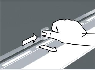
Дверца духовки оборудована **механическим замком**, который не позволяет открыть дверцу, пока замок закрыт.
