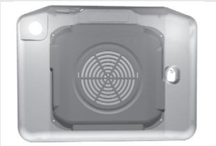
Задняя стенка духовки защищена **каталитической крышкой**. Снимать и устанавливать каталитическую крышку может только специалист сервисного центра.
