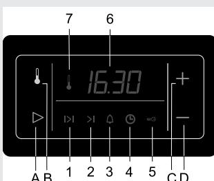
Nakon završenog pečenja, okrenite izborni prekidač na nulu. Iz sigurnosnih razloga, isključite i temperaturu na programskom satu. To napravite tako da istovremeno pritisnete tipke (C i D) i držite ih 3 sekunde. Time se prekinu i izbrišu sva vremenska podešavanja sata (vidi poglavlje »Podešavanje vremenskih funkcija«); sat se vrati na prikaz točnog vremena. Podešavanja možete izbrisati i tako da smanjite temperaturu na 30 °C i zatim još jednom pritisnete tipku (D).
