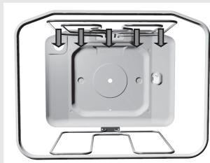
Ta sistem uporabite, če želite pečico čim hitreje ogreti na želeno temperaturo. Ni pa primeren za pečenje jedi.
