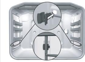
Die eingelegte leicht zu reinigende Innenauskleidung verhindert, dass das Fett beim Braten direkt auf die Innenwände des Backofens spritzt.
