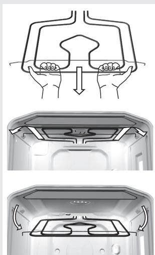
Entfernen Sie vor dem Reinigen des Backofens die Backbleche, den Rost und die Führungen und ziehen Sie dann das Heizelement waagrecht zu sich. Ziehen Sie das Heizelement so lange, bis sich die Querstange entriegelt und aus den Lagerungen auf der linken und rechten Seite des Backofens herauspringt (siehe Abb.).
