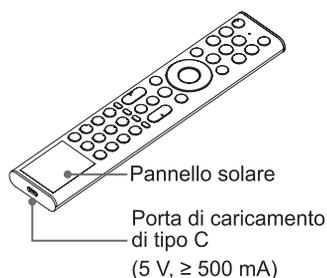
Si può caricare il telecomando esponendo il pannello solare alla luce del sole o usando un cavo USB di tipo C (non fornito).
