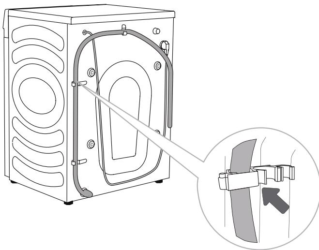
**D** Odvodno crijevo mora biti pričvršćeno na kuke na stražnjem dijelu stroja kako je prikazano na slici.
