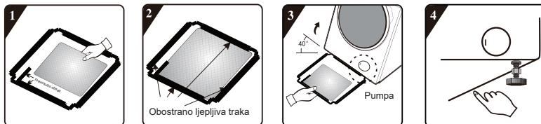
1. Prije postavljanja ploče za smanjenje buke, poravnajte i zalijepite vunu za apsorpciju zvuka s pravokutnim usjekom i duž njega na ploči za smanjenje buke (postupak je nepotreban za neke modele bez vune za apsorpciju zvuka).
