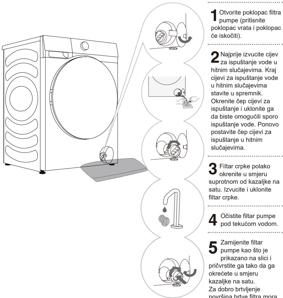
**1** Otvorite poklopac filtra pumpe (pritisnite poklopac vrata i poklopac će iskočiti).
