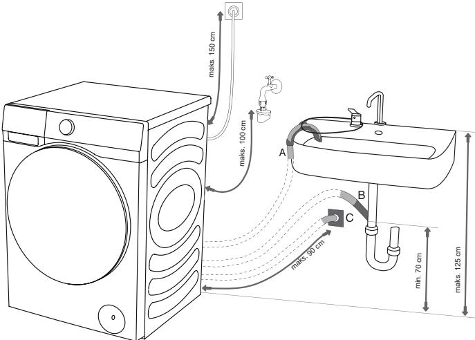
**C** Odvodno crijevo moguće je pričvrstiti i na zidni odvod s odjeljivačem koji treba biti pravilno ugrađen da bi ga bilo moguće očistiti.
