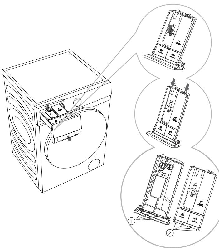
1. Otvorite odjeljak za deterdžent, pritisnite graničnu polugu kao što je prikazano na slici i izvucite odjeljak za deterdžent.
