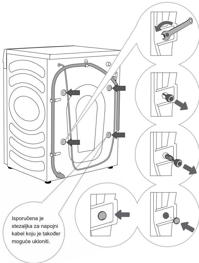
**1** Sklonite crijeva i pomoću ključa za nastavke olabavite četiri vijka na stražnjem dijelu uređaja okrećući ih u smjeru suprotnom od kazaljke na satu, kao što je naznačeno strelicom. Olabavite ih za oko 30 mm (ne potpuno).
