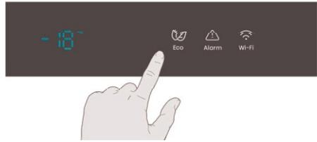
2. Mantenga presionado el botón Wi-Fi durante 3 segundos hasta que oiga un pitido y vea que la luz "Wi-Fi" parpadea después de encenderse constantemente durante unos segundos
