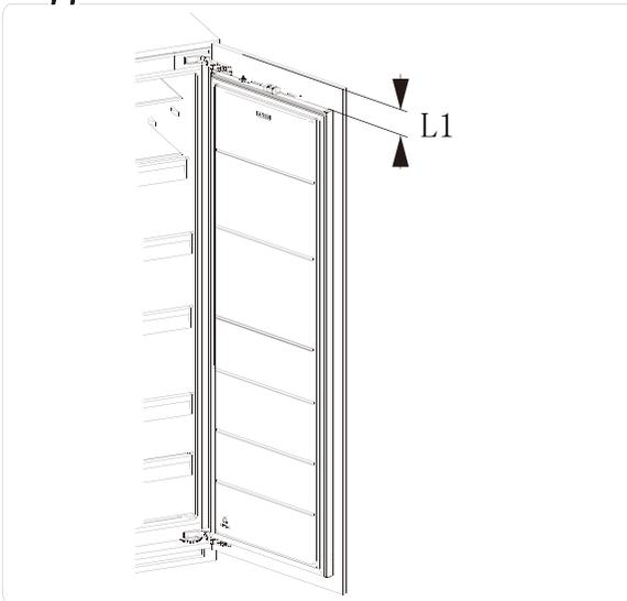
„L1“ ist der Abstand von der Oberseite der Schranktür zur Oberseite der Kühlschranktür, „T“ ist das Überlappungsmaß der Schranktür und der Seitenwand, vgl. Diagramm auf S. 20. „R“ ist der Abstand von der Oberseite der Schranktür zur Mitte des Lochs auf der Verbindungsplatte.
