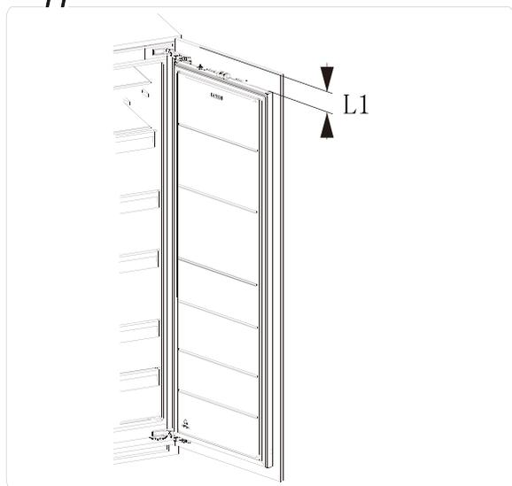
"L1" es la distancia desde la parte superior de la puerta del armario hasta la parte superior de la puerta del refrigerador. "T" es el tamaño de la solapa de la puerta del armario y la pared lateral, consulte el diagrama de la página 20, "R" es la distancia desde la parte superior de la puerta del armario hasta el centro del orificio de la placa de conexión.
