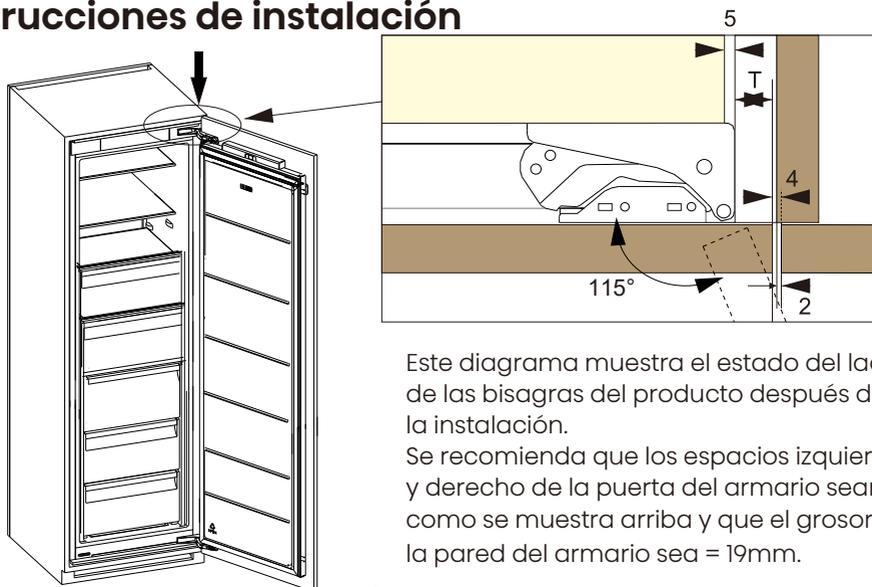
Este diagrama muestra el estado del lado de las bisagras del producto después de la instalación.
