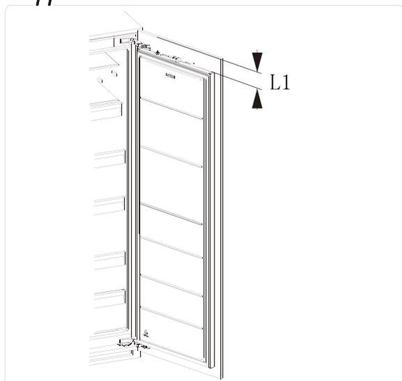
"L1" è la distanza dalla parte superiore dell'anta alla parte superiore della porta del frigorifero, "T" è la dimensione della porta dell'armadio e della parete laterale, fare riferimento allo schema a pagina 20, "R" è la distanza dalla parte superiore dell'anta dell'armadio al centro del foro sulla piastra di collegamento.
