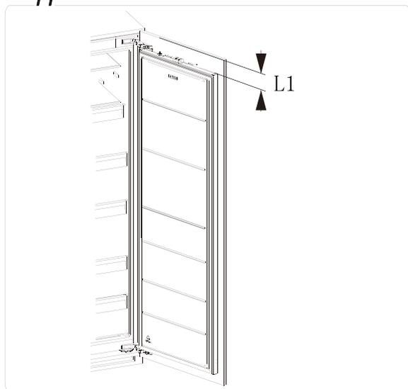
« L1 » est la distance entre le haut de la porte de l'armoire et le haut de la porte du réfrigérateur,
