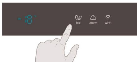
2. Houd de Wi-Fi-knop 3 seconden ingedrukt totdat u een pieptoon hoort en het "Wi-Fi"-lampje ziet knipperen nadat het een paar seconden constant brandt.
