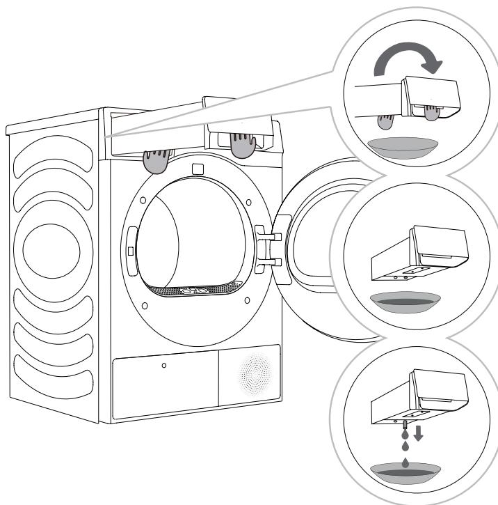
**1** Izvucite spremnik za kondenzat iz sušilice (objema rukama, kao što je prikazano na slici).
