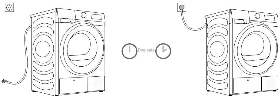
**⚠ Nakon postavljanja, sušilica se ne smije pomicati dva sata prije priključivanja na mrežno napajanje; time se omogućava stabilizacija sušilice.**
