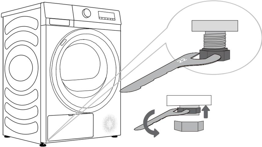
⚠ Der Boden, auf dem das Gerät aufgestellt wird, muss aus Beton sein. Er muss sauber und trocken sein, sonst kann das Gerät rutschen. Reinigen Sie auch die Unterseite der Einstellfüße.
