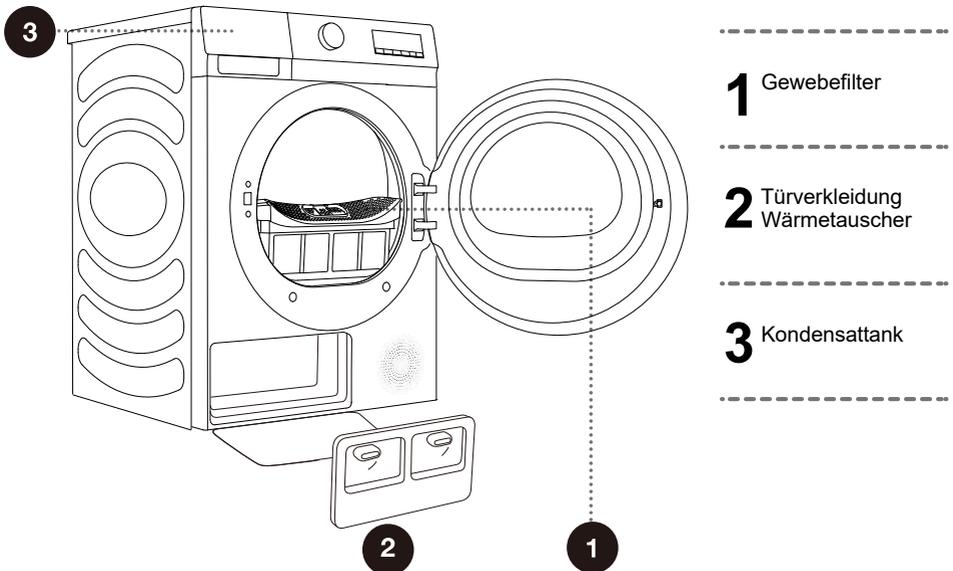
⚡ Betreiben Sie das Gerät keinesfalls ohne eingesetzte oder mit beschädigten Filtern, da sich Fasern aus dem Gewebe ansammeln und zu Fehlfunktionen oder Ausfällen des Geräts führen können.
