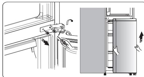
9. Placer den nederste låge på en glat overflade med panelet opad. Løsn skrue 3, og tag del 2 og del 1 ud. Installer den medfølgende udskiftningsstopper i lågens venstre side 4 (i plastikposen) og del 2 (stopklods) i venstre side med skrue 3. Opbevar del 1 sammen med apparatet til fremtidig reference.
