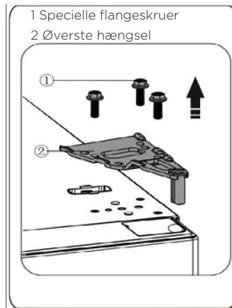
4. Tag den øverste låge af det midterste hængsel ved forsigtigt at løfte lågen lige op. Placer derefter den øverste låge på en glat overflade med dens øverste dæksel opad.
