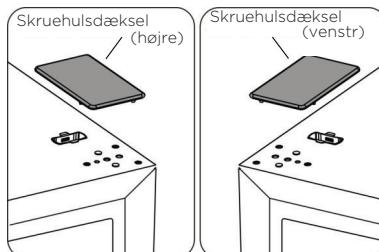
6. Fjern del 1 fra øverste venstre side af overdækslets. Fjern derefter del 3 fra øverste højre side af overdækslets. Installer del 1 fra øverste højre side af overdækslets.
