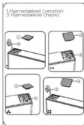
7. Løsn skrue 3, og tag del 2 og del 1 ud. Installer den medfølgende udskiftningsstopper i lågens venstre side 4 (i plastikposen) og del 2 (stopklods) i venstre side med skrue 3. Opbevar del 1 sammen med apparatet til fremtidig reference.
