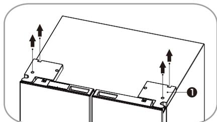
2. Déposez les vis (2) fixées sur les charnières supérieures avec une clé (5/16", 8 mm) et la vis de terre (3) attachée à la charnière avec un tournevis Phillips (+). Retirez la charnière supérieure de la porte gauche (4).
