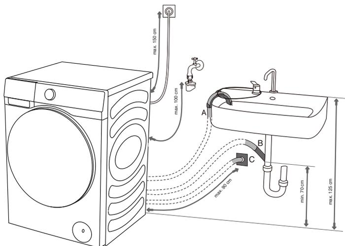
**C** Le tuyau d'évacuation peut également être fixé à un drain mural avec un siphon ; ce siphon doit être correctement installé pour permettre le nettoyage.
