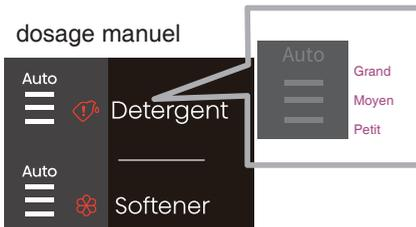
Il est possible de sélectionner manuellement la dose désirée de la lessive. On peut régler soi-même la dose désirée de la lessive. Il existe trois niveaux, à savoir petit, moyen et grand. Le dosage manuel est sélectionné lorsque l'icône Auto ne s'allume pas et que les lignes peuvent être sélectionnées (petit, moyen, grand).
