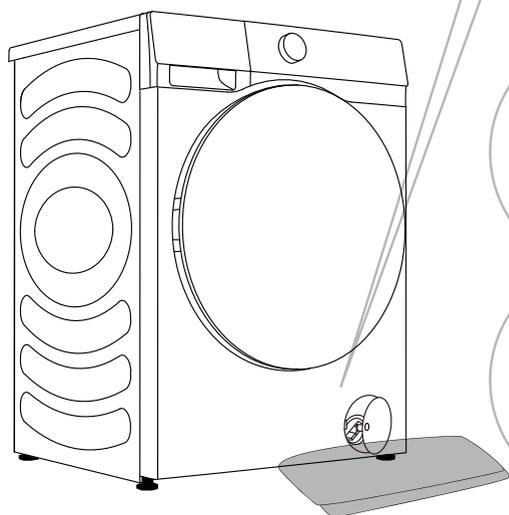
**1** Ouvrir le bouchon du filtre de la pompe à l'aide d'un outil approprié (appuyer sur le couvercle de la porte pour le faire ouvrir automatiquement).
