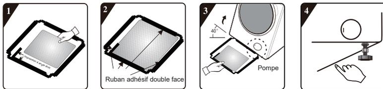
1. Avant d'installer le panneau de réduction du bruit, alignez et collez la laine d'absorption acoustique avec et le long de l'impression à angle droit sur le panneau de réduction du bruit (cette procédure n'est pas nécessaire pour certains modèles sans laine d'absorption acoustique).
