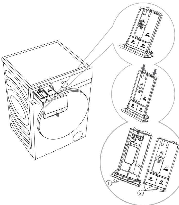
1. Ouvrez le compartiment à détergent, appuyez sur le levier de verrouillage comme indiqué sur la figure et retirez le compartiment à détergent ;
