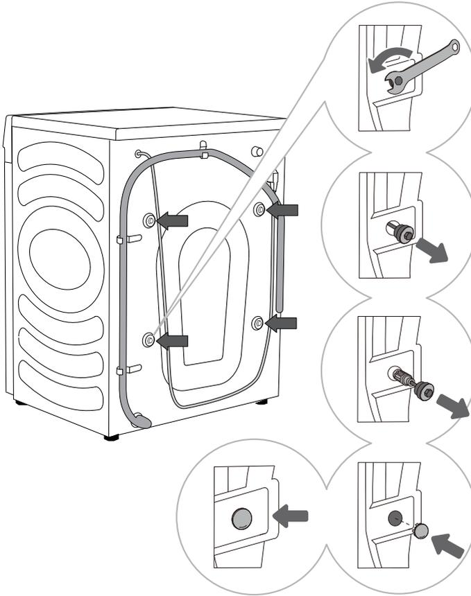
**1** Écarter les tuyaux de côté et utiliser une clé de serrage pour desserrer les 4 vis à l'arrière de l'appareil en les tournant dans le sens inverse des aiguilles d'une montre, comme indiqué par la flèche. Desserrer-les d'environ 30 mm (pas complètement).
