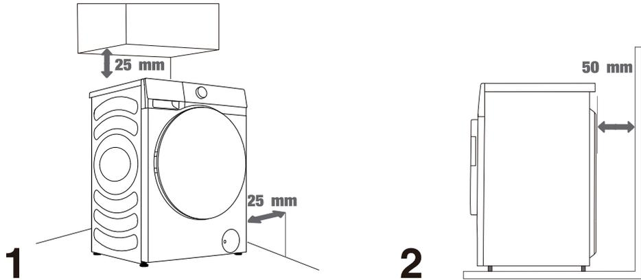
☼ Le lave-linge ne doit pas être en contact avec un mur ou un meuble adjacent. Pour un fonctionnement optimal du lave-linge, il est recommandé de respecter les dégagements par rapport aux murs comme indiqué sur la figure.
