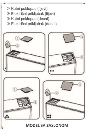
7. Odvijte vijak ③ i skinite dio ② i dio ①, pomoću vijka ③ ugradite zamjenski zaustavnik vrata ④ (koji se isporučuje i plastičnoj vrećici) na lijevu stranu. Dio ① sačuvajte s uređajem za buduću uporabu.
