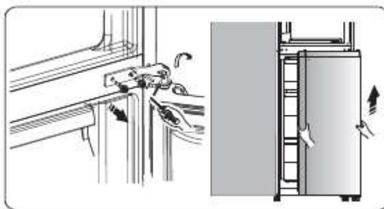
9. Položite donja vrata na glatku površinu s gornjom pločom okrenutom prema gore. Odvijte vijak ③ i skinite dio ① i dio ② zatim pomoću vijka ③ ugradite zaustavnik vrata ④ (koji se isporučuje i plastičnoj vrećici) te lijevi dio ② i vijak ③ na lijevu stranu i dobro ih pritegnite. Dio ① sačuvajte s uređajem za buduću uporabu.
