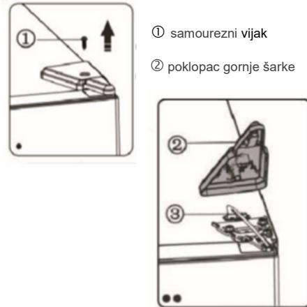
3. Odvijte vijke ① i šarke ②. Kod hladnjaka sa zaslonom na vratima morate zaobići priključak ③ kroz otvor šarke. (Prilikom ugradnje gornja vrata držite rukom.)
