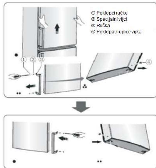
**Upozorenje!** Kad mijenjate stranu na koju se vrata otvaraju, uređaj ne smije biti spojen na mrežu. Prije toga izvucite utikač iz dovoda struje.
