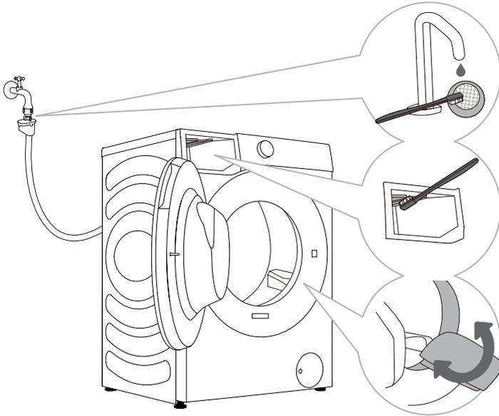
**1** Reinigen Sie den Siebfilter regelmäßig unter fließendem Wasser.
