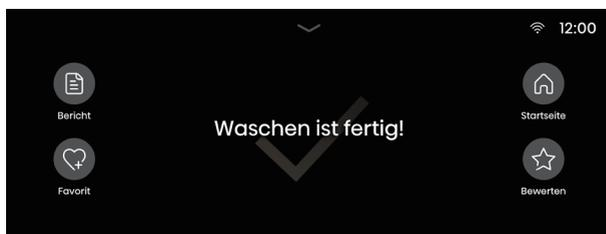
Am Ende des Programms gibt die Waschmaschine einen Signalton ab, im Display wird das Ende des Programms angezeigt, und Sie können die Ein/Aus-Taste drücken, um die Waschmaschine auszuschalten. Wenn innerhalb von 10 Minuten keine Bedienung erfolgt, schaltet sich die Waschmaschine automatisch aus.
