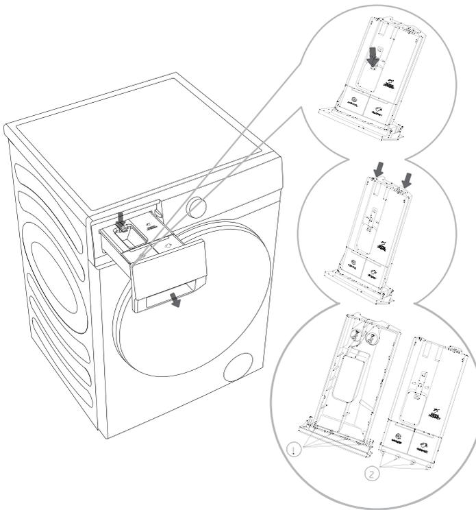
1. Öffnen Sie die Waschmittelschublade, drücken Sie den Begrenzungshebel wie in der Abbildung gezeigt und ziehen Sie die Waschmittelschublade heraus.
