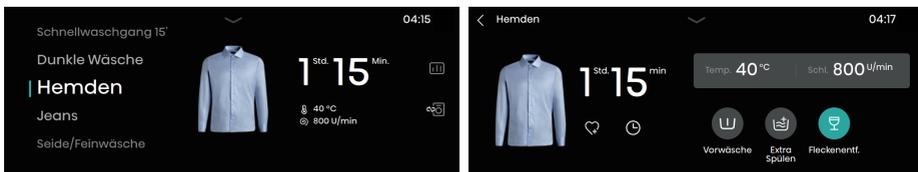
Tippen Sie auf die gewählte Programmzeit, um die Einstellungen für Temp. und Schleudern zu ändern und zusätzliche Funktionen wie Vorwäsche, Extra Spülen, Dampf, Schnell, UV, Knitterschutz, Intensiv, Leise und Fleckenentf. einzustellen. Weitere Zusatzfunktionen können durch Wischen nach links und rechts angezeigt werden. Die wählbaren Zusatzfunktionen hängen vom jeweiligen Programm ab.
