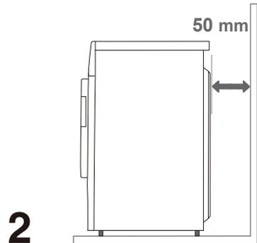
⚠ Die Waschmaschine darf nicht mit einer Wand oder einem Möbelstück in Berührung kommen. Um einen optimalen Betrieb zu gewährleisten, lassen Sie um die Waschmaschine herum etwas Platz, wie in der Abbildung angegeben.
