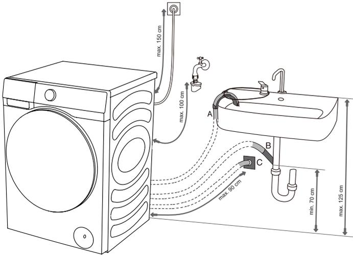
**C** Der Abflussschlauch kann ebenfalls an einem Abfluss mit Siphon befestigt werden, der ordnungsgemäß installiert sein muss, um eine Reinigung zu ermöglichen.
