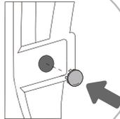
**💡** Bewahren Sie die Transportbolzen für einen späteren Transport auf (um die Transportbolzen wieder einzubauen, führen Sie die obigen Anleitungen in umgekehrter Reihenfolge durch).
