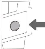
**4** Decken Sie die Schraubenlöcher mit den Kunststoffkappen ab. Die Kunststoffkappen finden Sie im Zubehör-Set zusammen mit der Bedienungsanleitung.
