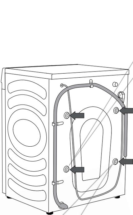
Hier befindet sich auch eine Kabelklemme, die ebenfalls entfernt werden muss.
