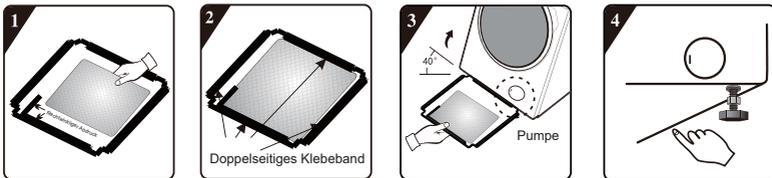
1. Richten Sie die Schalldämmwolle vor dem Einbau der Schallschutzplatte aus und kleben Sie sie entlang der rechtwinkligen Vertiefung auf die Schallschutzplatte (bei einigen Modellen ohne Schalldämmwolle ist dieser Vorgang nicht erforderlich).
