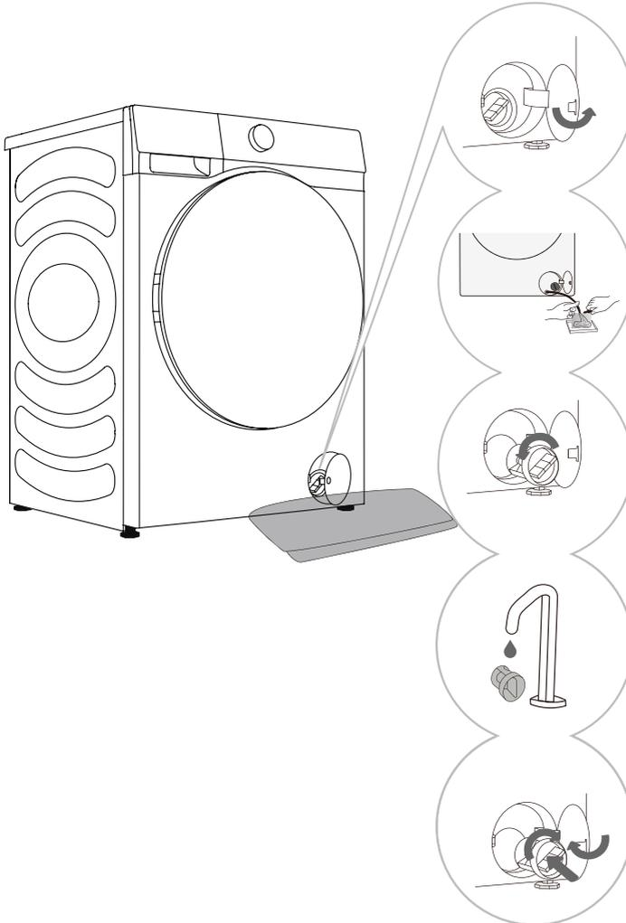
**1** Öffnen Sie den Pumpenfilterdeckel mit einem geeigneten Werkzeug (drücken Sie auf den Deckel an, er springt dann auf).
