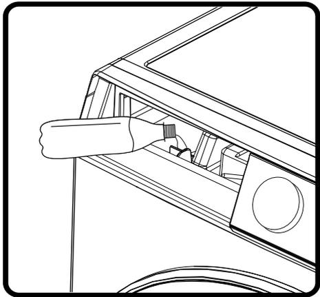
Das Filtersieb des Wassertanks kann nach langem Gebrauch durch Verunreinigungen verstopft sein. Wir empfehlen, es monatlich zu reinigen. Greifen Sie mit den Fingern in das untere Filtergewebe des Wassertanks und nehmen Sie es heraus. Setzen Sie es nach dem Waschen wieder ordnungsgemäß ein.
