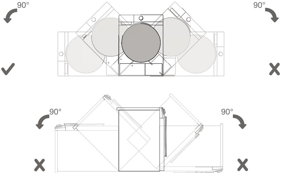
⚡ Warten Sie nach der Installation 24 Stunden, ohne das Gerät zu bewegen, bevor Sie es zum ersten Mal benutzen. Wenn der Trockner während des Transports oder der Wartung auf eine Seite gelegt werden muss, legen Sie ihn nur mit der linken Seite, von der Vorderseite des Geräts aus gesehen, nach unten.
