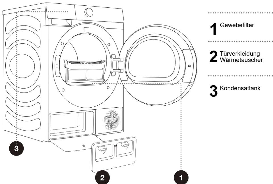
⚠ Betreiben Sie das Gerät keinesfalls ohne eingesetzte oder mit beschädigten Filtern, da sich Fasern aus dem Gewebe ansammeln und zu Fehlfunktionen oder Ausfällen des Geräts führen können.
