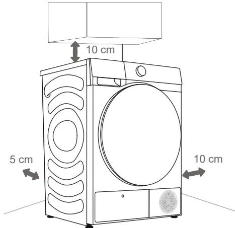
☼ Das Gerät darf nicht mit einer Wand oder einem Möbelstück in Berührung kommen. Um einen optimalen Betrieb zu gewährleisten, lassen Sie um das Gerät herum etwas Platz, wie in der Abbildung angegeben. Wenn Sie die erforderlichen Mindestabstände nicht einhalten, kann es zu einer Überhitzung kommen.
