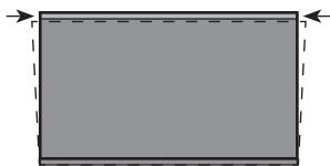
Draai de linker en rechter voorvoeten met de klok mee.
