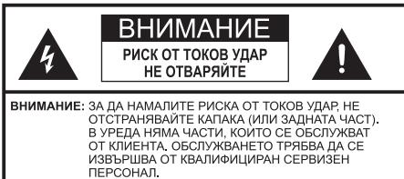
Символът на светкавица със стрелка в равностранен триъгълник е предназначен да предупреди потребителя за наличието на неизолирано опасно напрежение в корпуса на продукта, което може да достигне значителна стойност и да представлява рисък от токов удар.
