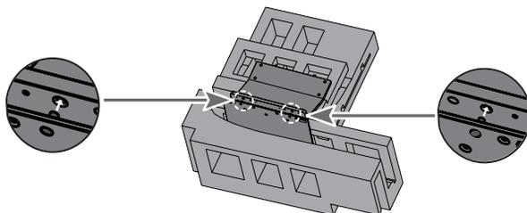
4. Utilizzare la mano e tenere assieme le Parti A e B della base di supporto. Utilizzare 7 viti (M5 × 16) per montarle saldamente.
