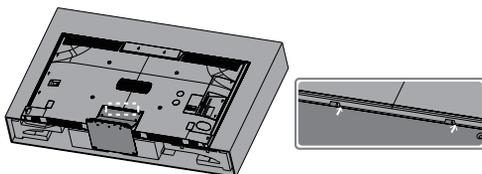
9. Utilizzare quattro viti (M5 × 16) per assicurare saldamente la Base di supporto montata al televisore.
