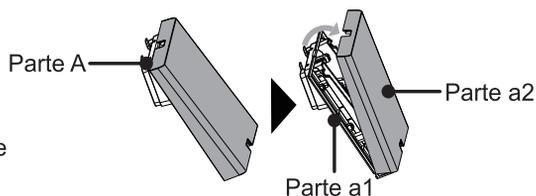
3. Installare la Parte a1 sull'involucro posteriore del televisore.
