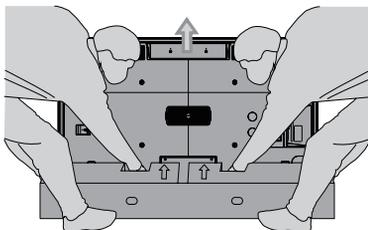
7. Due persone posizionano il televisore sulla scatola montata con lo schermo rivolto verso il basso. Assicurarsi che la superficie della scatola montata sia pulita e liscia.
