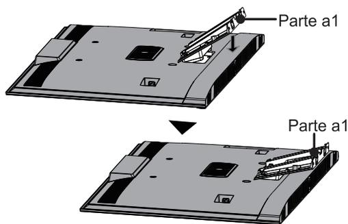
4. Assicurare la Parte a1 con 4 viti (M5 × 12) sull'involucro posteriore del televisore.
