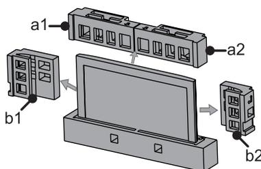
2. Posizionare il Cuscino superiore a1 e il Cuscino laterale b1 come mostrato nella figura, e mettere le Parti A e B della base di supporto su di essi per prepararsi all'installazione della Base di supporto.
