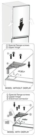
16. Connect electrical connector<sup>①</sup>
