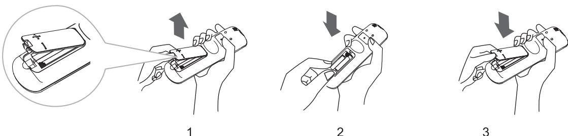
• **Poznámka:** Použijte dvě LR03 AAA(1.5volt) baterie. Nepoužívejte nabíjecí baterie. Vyměňte baterie za nové stejného typu, když začne displej na dálkovém ovladači blednout.
