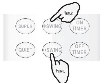
Напрямок повітряного потоку також регулюється за допомогою кнопок на пульти ДК.
