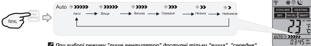
При виборі режиму "лише вентилятор" доступні тільки "вища", "середня", "низька" швидкості.
