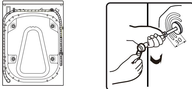
2. Толкните четыре транспортировочных винта горизонтально внутрь машины и ослабьте их.
