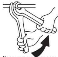
Застосування двостороннього гайкового ключа
