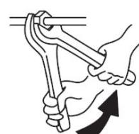
(3) Затегнете гайката с два гаечни ключа, както е показано на дясната фигура.
