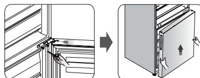
10. Поставете долната врата на гладка повърхност с панела нагоре. Развийте винт 3 и свалете част 2 и част 1, след това инсталирайте левия стопер на вратата 4 и ляв стопер 5 (в торбичката) отляво и затегнете добре ключ 3.
