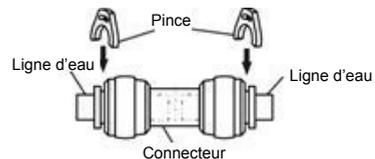
Ouvrez le robinet d'eau pour vider les conduites et vérifiez s'il y a des fuites d'eau au niveau des connecteurs. En cas de fuite, vérifiez que les lignes sont complètement insérées là où le connecteur a une fuite. Si ce n'est pas le cas, veuillez les réinstaller et resserez-vous que les lignes sont bien insérées.
