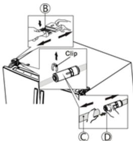
3. Enlevez les 3 vis (B) fixés sur la charnière avec une clé (8mm) et 1 vis de terre (C) attaché à la charnière avec le tournevis Phillips (+). Enlevez les charnières supérieures gauches et droites de la porte (D).
