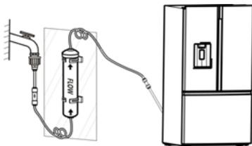
● Les conduites d'eau ne doivent pas être pressées par des objets lourds et ne doivent pas être pliées.
