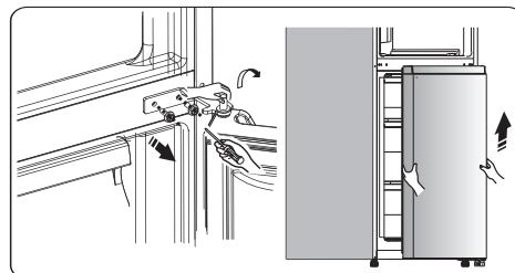
9. Поставете долната врата на гладка повърхност с панела нагоре. Развийте винт 3 и свалете част 2 и част 1. Монтирайте заместващия стопер на вратата вляво 4, предоставен (в найлоновия плик) и част 2 (блока на стопера) от лявата страна с винт 3. Пазете част 1 с уреда за бъдещо ползване.
