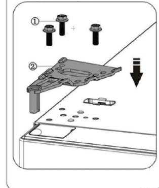
16. Фиксирайте част 1 с винт 2, вижте стъпка 2.
