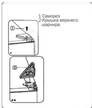
3. Открутите винты 1 и снимите шарнир 2.
