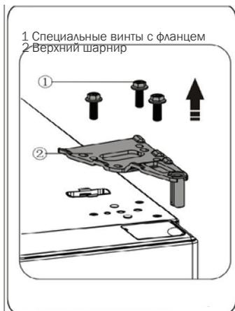
4. Приподнимите верхнюю дверцу и аккуратно снимите со среднего шарнира. Положите дверцу на мягкую поверхность, повернув лицевой панелью вверх.
