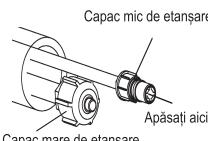
b. Conectați conductele unității interioare cu două chei. Acordați o atenție deosebită cuplului permis, aşa cum se arată mai jos, pentru a preveni deformarea și deteriorarea conductelor, conectorilor și piulițelor conice de siguranță.
