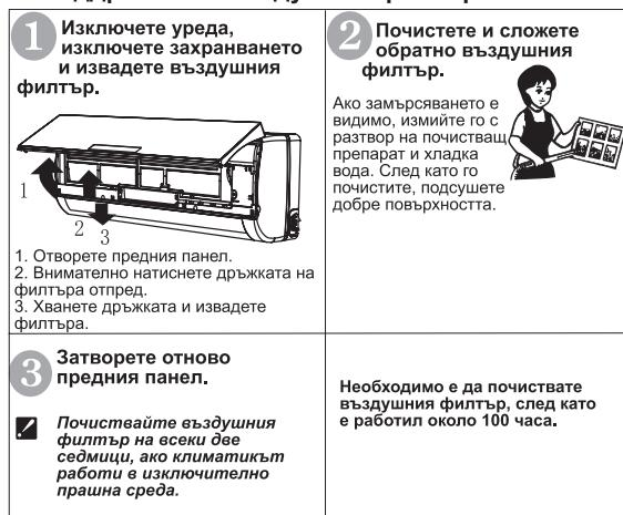
◆ Поддръжка на экрана на въздушния филтър и на пречистващия филтърен елемент (моля, вижте фигуранта по-долу)
