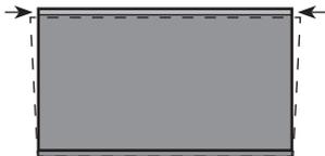
Si le haut de l'image est plus étroit que l'écran, utilisez la clé pour faire pivoter les pieds gauche et droit du TV Laser dans le sens des aiguilles d'une montre jusqu'à ce que les bords gauche et droit de l'image soient parallèles aux bordures de l'écran. Ensuite, déplacez la console plus loin de l'écran pour remplir l'image à la largeur de l'écran.
