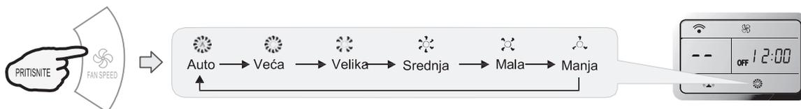
☑ **U režimu „SAMO VENTILATOR“, „AUTO“ brzina nije dostupna. U režimu „SUŠENJE“, brzina ventilatora je automatski podešena na „AUTO(MATSKU)“ i tada dugme „FAN“ (ventilator) nema efekata.**
