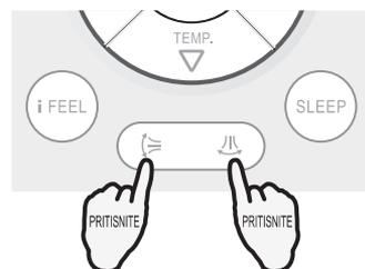
Smjer strujanja zraka možete podesiti po želji pritiskom tipke "⏮ ⏭" na daljinskom upravljaču.
