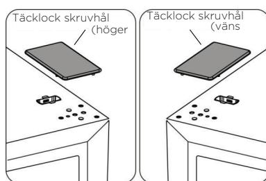
6.Ta bort del 1 från den övre vänstra sidan på det övre locket och ta ut del 2. Ta sedan bort del 3 från den övre högra sidan på det övre locket. Se ovanstående åtgärd, montera del 3 och 4 på den övre vänstra sidan av det övre locket.
