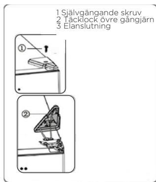
3. Ta bort skruvarna 1 och gångjärn 2. För sedan kontakt 3 genom hålet på gångjärn 2. (Håll fast den övre dörren för hand när du installerar).
