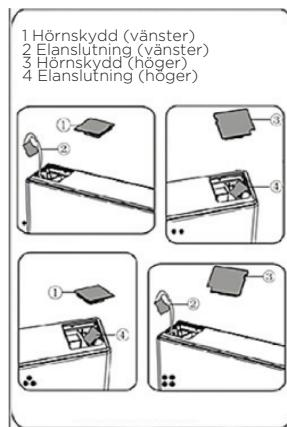
7.Lossa skruv 3 och ta ner del 2 och del 1, installera reservdelen dörrstopp vänster 4 (i plastpåsen) och del 2 (stoppblock) på vänster sida med skruv 3. Spara del 1 för framtida referens.
