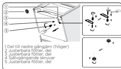
12. Ta bort del 3 från det nedre gångjärnsstiftet, lirka ut det nedre gångjärnsstiftet, flytta detta till hålet på motsatt sida och skruva fast, installera sedan del 3 på det nedre gångjärnsstiftet.
