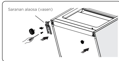
14. Aseta alao vi alempaan saranatappiin ja pidä se paikallaan. Käännä keskisanaa 180°, vaihda akselin aluslevy alapuolelle, säädä keskisarana sopivaan asentoon ja asenna se varmistaen, että alao vi on kiinnitetty kunnolla paikalleen.
