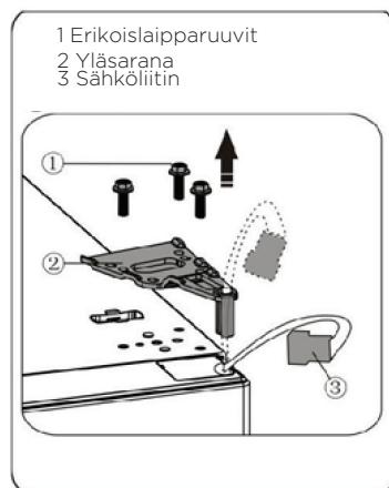
4. Irrota yläovi keskisanasta nostamalla ovi varovasti suoraan ylös. Aseta sitten yläovi tasaiselle alustalle yläkansi ylöspäin.
