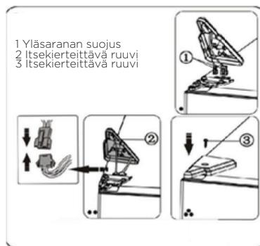
17. Avaa yläovi, asenna ovihyllyt ja sulje ovi. Huom: Jos laitteessasi on kahva, se on vaihdettava toiselle puolelle alla olevien ohjeiden mukaisesti. Irrota yläovi ja aseta se tasaiselle alustalle paneeli ylöspäin. Vipua osaa 1 ja osaa 4, ja löysää sitten ruuvit 2 kuvan mukaisesti. Vaihda kahva 3 oikealle puolelle ja asenna sitten ruuvit 2, osa 1 ja osa 4 vuorollaan.
