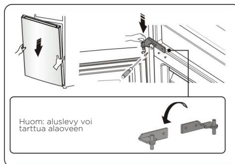
15. Aseta yläovi sopivaan asentoon, ja kiinnitä sitten osa 2 ruuveilla 1. Ennen kuin kiinnität osan 2, vie liitin 3 saranan 2 kautta (katso vaihe 3). (Pitele yläövea käsin asennuksen aikana.)
