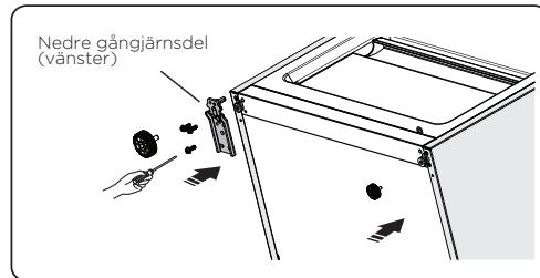
14. Placera den nedre dörren på det nedre gångjärnsstiftet och håll på plats. Vrid det mellersta gångjärnet 180°, flytta brickan på axeln till undersidan, justera mittgångjärnet till lämplig position och installera det så att den nedre dörren säkras.
