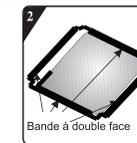
Retirez le papier de surface sur la bande à double face à quatre côtés de la plaque inférieure.
