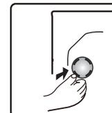
**Important:** Conservez les boulons de transport ainsi que la clé en cas de transport futur de l'appareil. Dans ce cas, réinstallez les boulons en séquence inverse.
