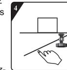
Pressez manuellement la bande à double face sur quatre côtés pour fixer fermement la plaque antibruit sur le corps de la machine.
