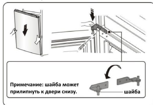
15. Переместите верхнюю дверь в подходящее положение, а затем закрепите деталь ② винтами ①. Прежде чем закрепить деталь ②, пропустите коннектор ③ через петлю ②, как описано в шаге 3. (При установке держите верхнюю дверь рукой).
