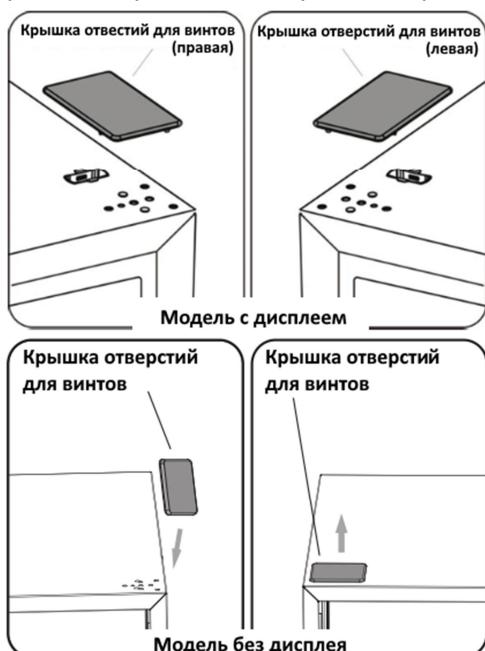
6. Если холодильник снабжен дисплеем на двери, снимите деталь ① с верхней левой стороны верхней крышки и выньте деталь ②. Затем снимите деталь ③ и вставьте деталь ④ в верхнюю правую сторону верхней крышки. Обратитесь к описанной выше операции, установите деталь ③ и деталь ④ на верхнюю левую сторону верхней крышки. Установить деталь ① верхней правой стороны верхней крышки. Если холодильник не снабжен дисплеем на двери, пропустите этот шаг.
