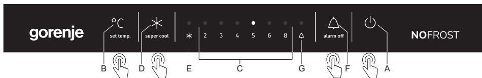
**A Tipka za uključenje/isključenje uređaja**
